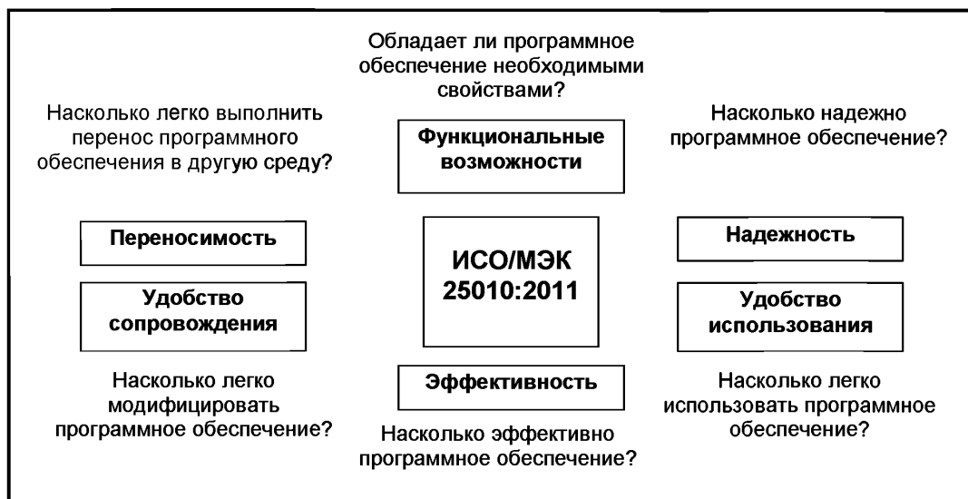
Рисунок 1 – Модель оценки качества программного обеспечения по ИСО/МЭК 25010:2011
