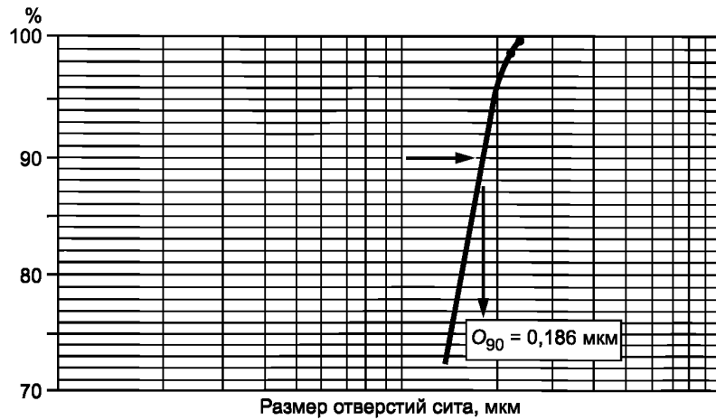
Рисунок Ж.5 — Суммарная диаграмма состава гранулированного материала, прошедшего сквозь пробу, и определение O_{90}
