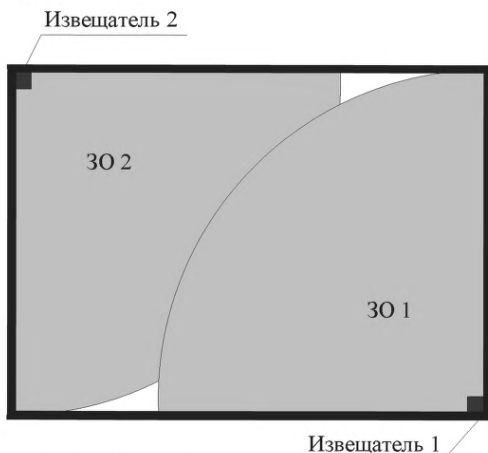
Рисунок 5.10 – Блокировка помещений, размеры которых превышают максимальную рабочую дальность действия извещателя (2 извещателя)
