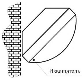
б) на стене под углом 45°, вид сверху
