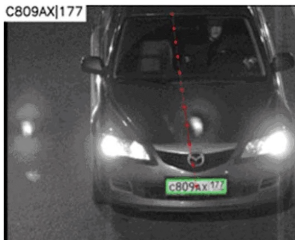
Рис. 63 - Работа модуля компании «СИНЕЗИС» по распознаванию автомобильных номеров
