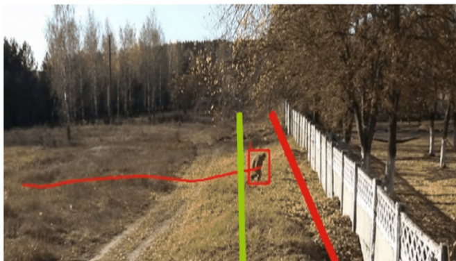
Рис. 64 - Пример обнаружения движения нарушителя в запретной зоне
