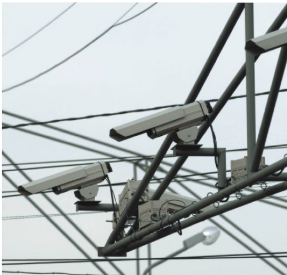
Рис. 50 - Размещения камер системы распознавания номеров на консоли. Обратите внимание на выдвинутый кожух камеры, который предохраняет объектив от посторонней засветки
