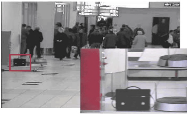
Рис. 47 - Распознавание оставленного предмета модулем «Orwell 2k-City»
