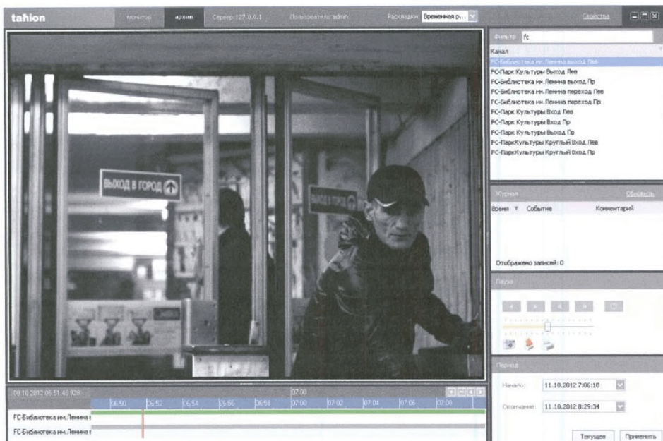
Рис. 85 - Детектирование факта прохода пассажира без билета (регистрация направления движения)
