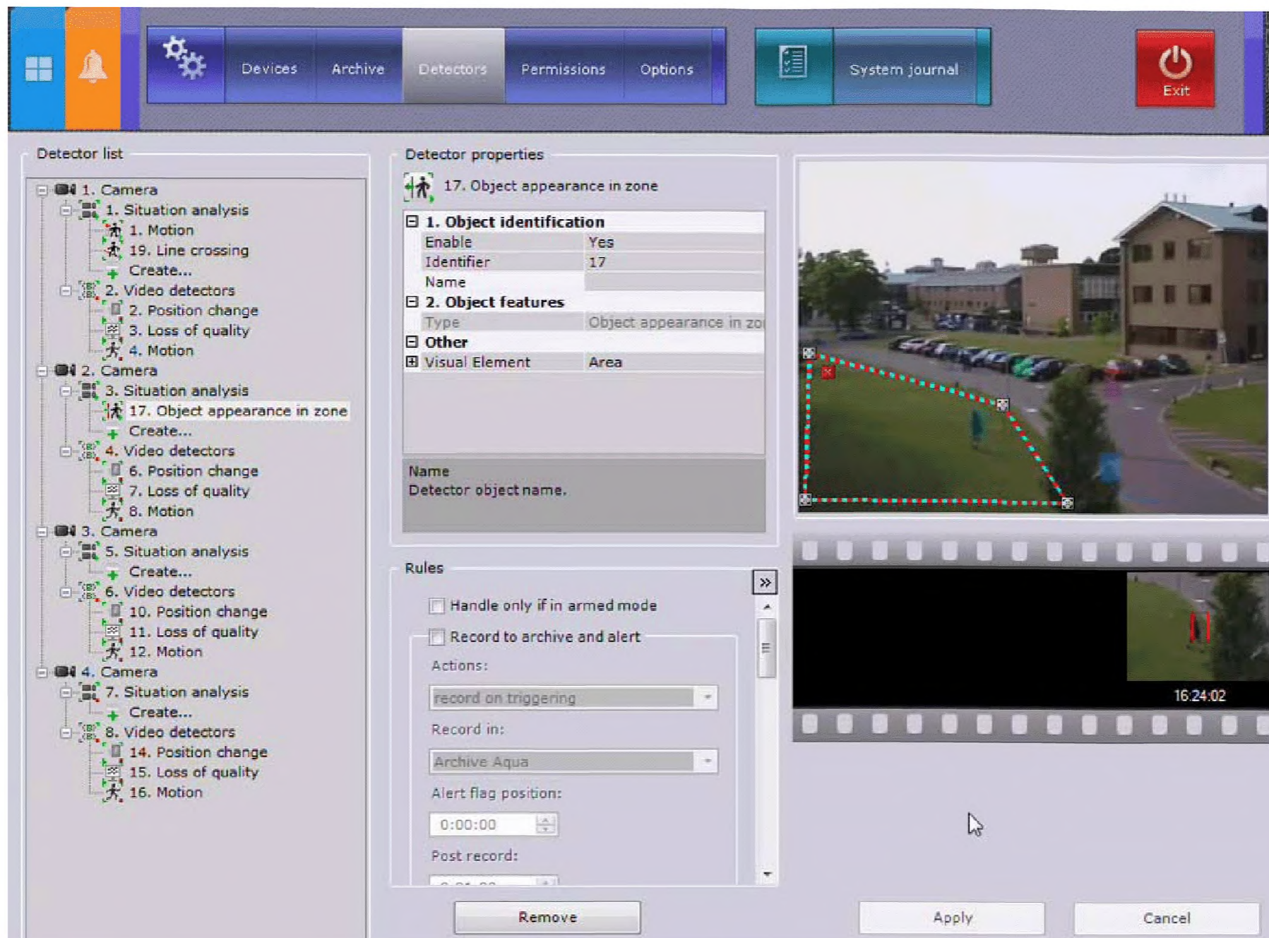
Рис. 27 - Детектирование начала и/или прекращения движения объекта в заданной области поля зрения видеокамеры
