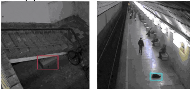
Рис. 48 - Распознавание оставленного предмета модулем компании «СИНЕЗИС»
