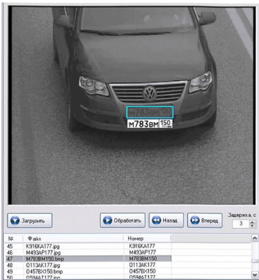
Рис. 56 - Интерфейс модуля распознавания и регистрации автомобильных номеров компании «ЭЛВИС»
