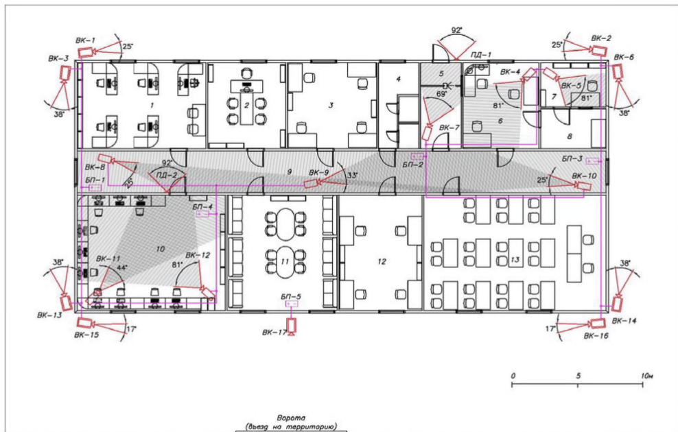
Рис. 17 Схема системы видеонаблюдения для ПЦО подразделения вневедомственной охраны с возможными зонами действия с возможными зонами действия детектора дыма и пожара
