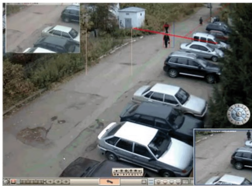
Рис. 99 - Два человека воспринимаются видеоаналитикой как вытянутый в вертикальной плоскости объект
