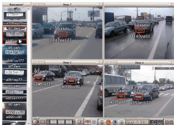
Рис. 58 - Работа программного модуля «SL-Traffic»
