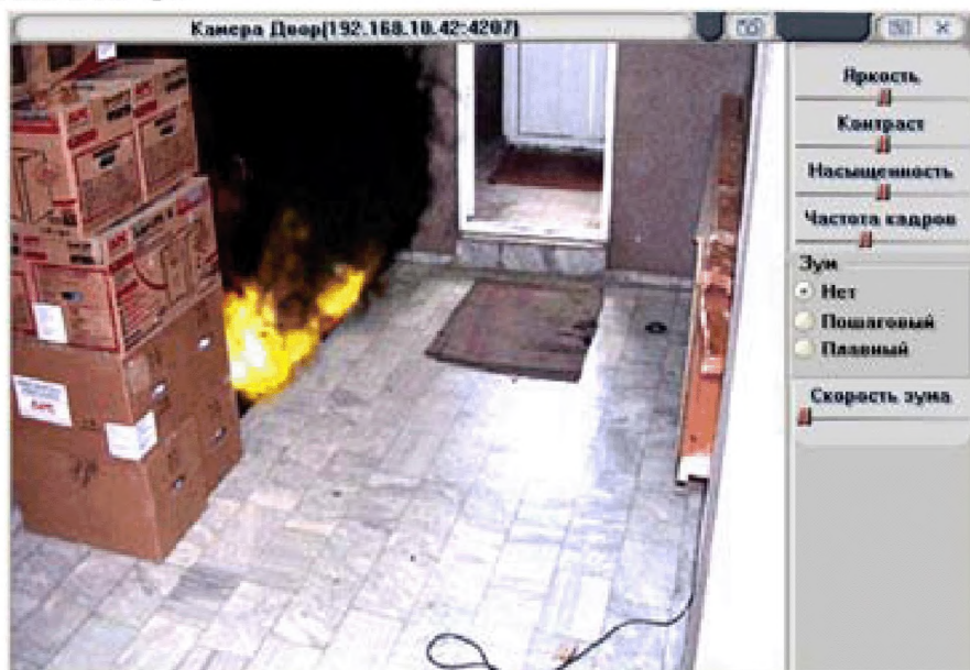
Рис. 75 - Работа видеодетектора дыма и огня компании «ИНТЕГРА-С»
