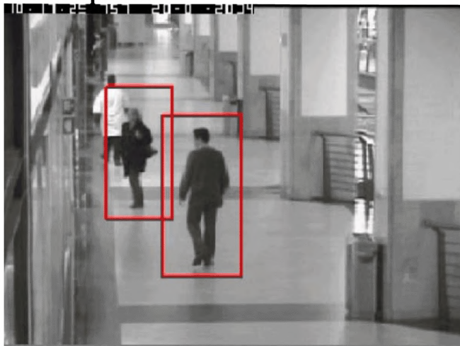
Рис. 35 - Обнаружение человека в видеопотоке системой поиска и классификации объектов компании «Транзас»
