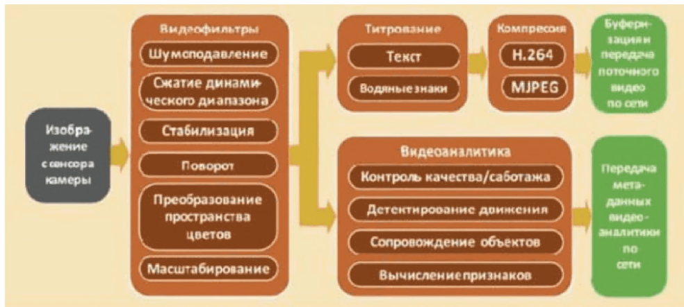
Рис. 1А - Конвейер обработки видео интеллектуальной IP - камеры
