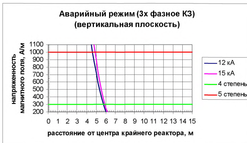
Рис.В.18 Распределение НМП при аварийных режимах в вертикальной плоскости при Z=0,25 Ом; n=34 ; R=0,6 м; S=2,4 м
