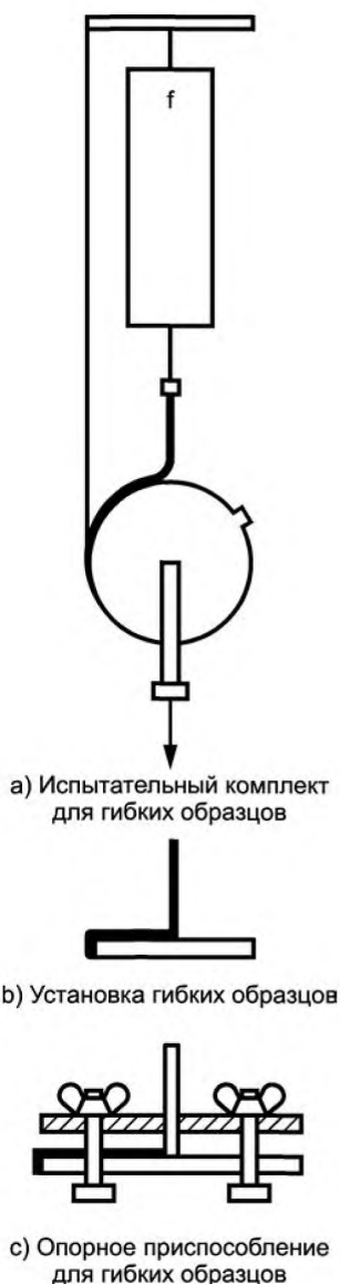
Рисунок 13 — Измерительное оборудование для испытания гибких печатных плат на отрыв
