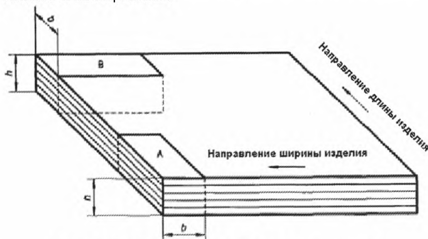
Рисунок 3 — Расположение образцов для испытания
