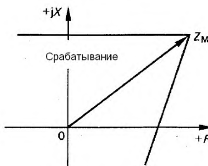
Рисунок 1b — Характеристика реактивного сопротивления
