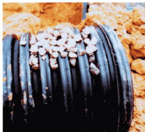
Рисунок 9.55 – Фрагмент расположения частиц грунта на гофрированной поверхности ТПСС
