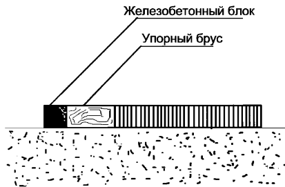
Рисунок 9.2 – Установка бруса по окончании работ
