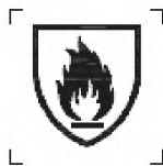
Рисунок 1 — Символ в соответствии с ИСО 7000-2417. Пиктограмма для обозначения одежды для защиты от тепла и пламени
