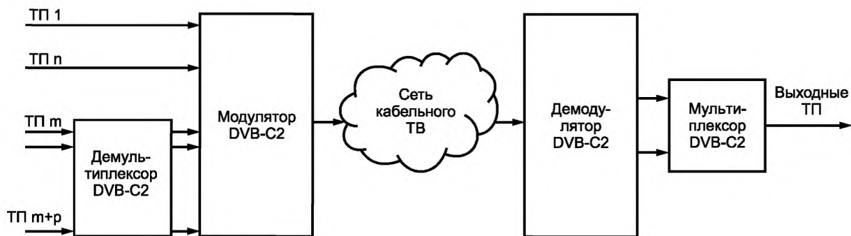
Рисунок Б.1 — Расширение функциональных возможностей системы DVB-C2 при использовании демультимплексирования и мультиплексирования
