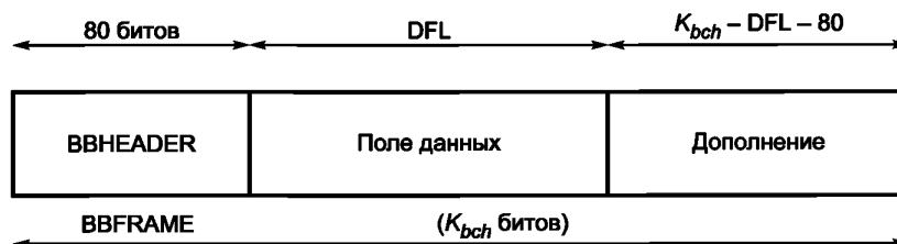
Рисунок 12 — Формат кадра BBFrame на выходе адаптера потока
