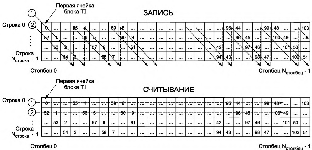
Рисунок 32 — Перемежение времени данных сигнализации L1 ( N_{MOD\_TOTAL} = 208 , N_{L1\_TI\_DEPTH} = 4 )
