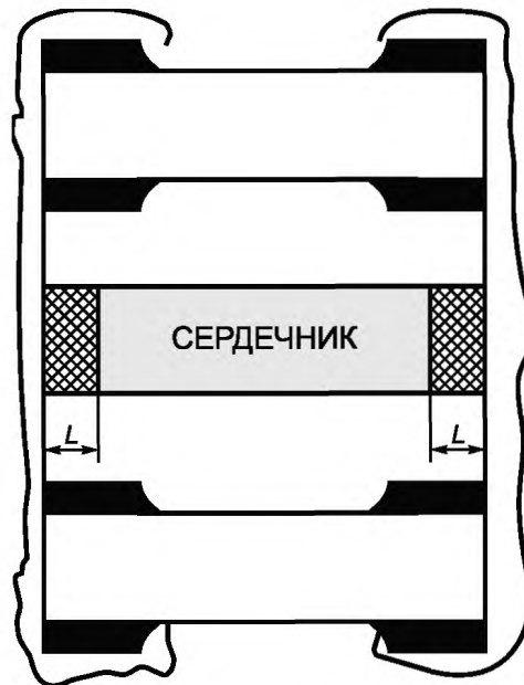
Рисунок 14 — Расположение металлического сердечника в сквозном металлизированном отверстии
