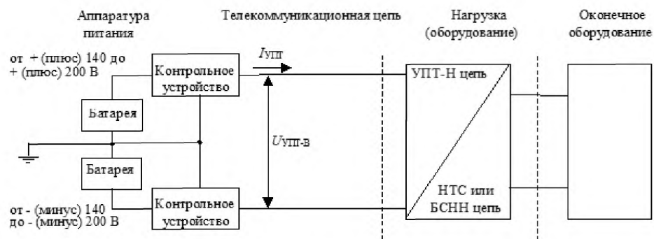
Рисунок 2 – Пример УПТ-Н системы удаленного электропитания
