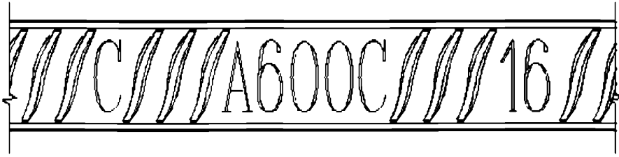
Рисунок 5.1 – Маркировка арматурного проката класса А600С
