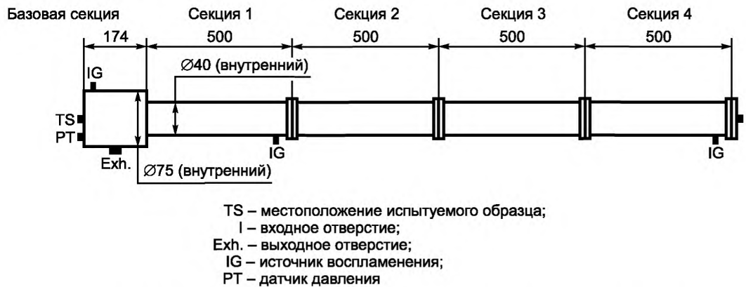
Рисунок 21 — Установка для испытаний дыхательных и дренажных устройств
