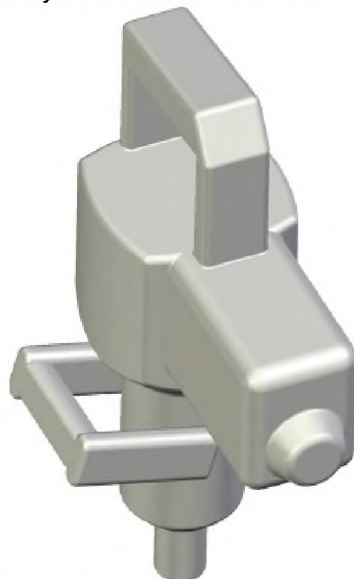
Рисунок 6 – Отбойный молоток с поддерживающей рукояткой
