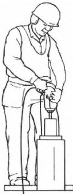
Рисунок 18 – Рабочая поза оператора при испытаниях отбойных, обрубных и клепальных молотков для анкерных работ и легких бурильных молотков
