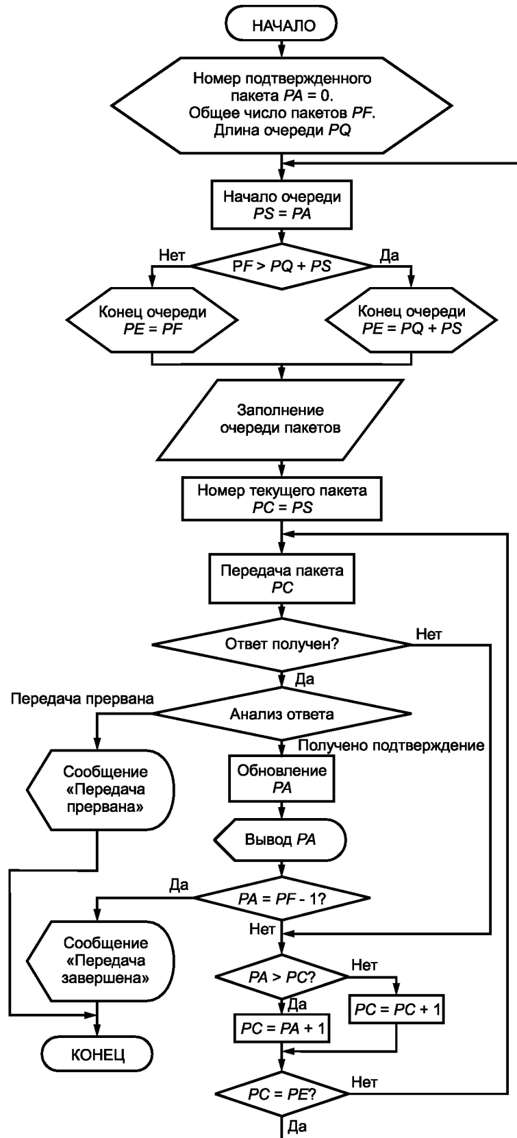
Рисунок 7 — Блок-схема алгоритма процесса передачи данных файла
