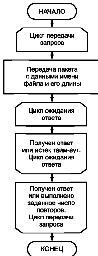
Рисунок 6 — Блок-схема алгоритма процесса запроса на передачу файла и ожидания ответа
