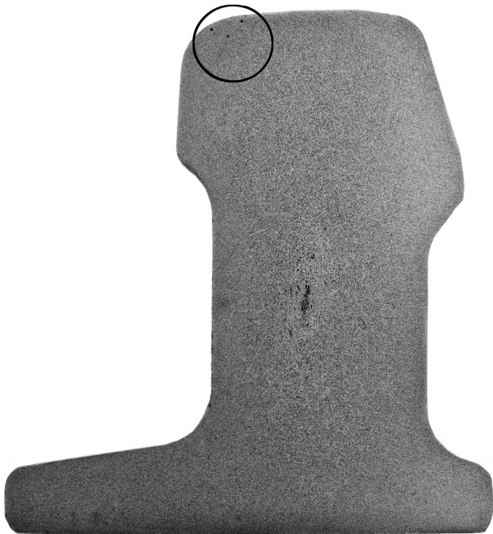
Рисунок Ж.4 — Точечная неоднородность в головке рельса
