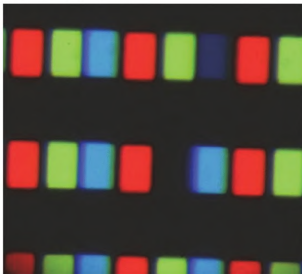
Рисунок 18 – Дефект субпикселя в ЖКИ, работающем на пропускание и отражение, в темноте
