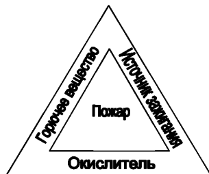
Рисунок 2 – Возникновение пожарной опасности
