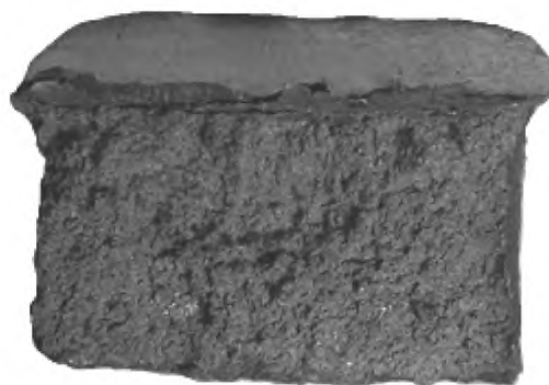
Рисунок Б.1 — Излом мелкозернистый, матовый
