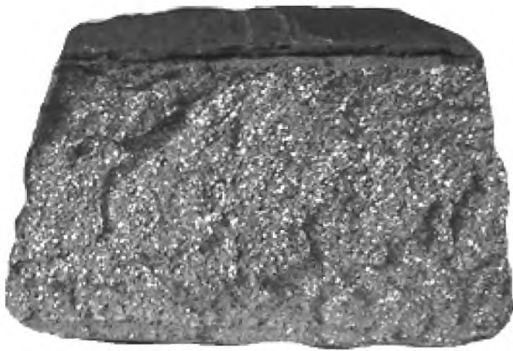
Рисунок Б.10 — Излом мелкозернистый, кристаллический
