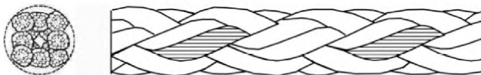
Рисунок 1 — Конфигурация 8-рядного плетеного каната (тип L)
