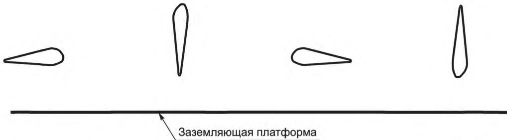
Рисунок D.2 — Возможные положения лопасти для испытаний на приложение начального лидера по схеме А
