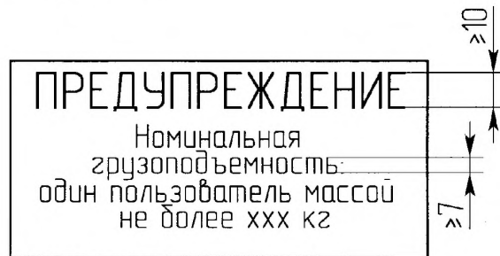
Рисунок 15 - Образец стандартной надписи с информацией о грузоподъемности
