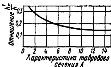
Рис. 14. Значения отношения \frac{h''_n}{h} в зависимости от характеристики таврового сечения
