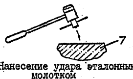
Нанесение удара обычным молотком по головке эталонного молотка
