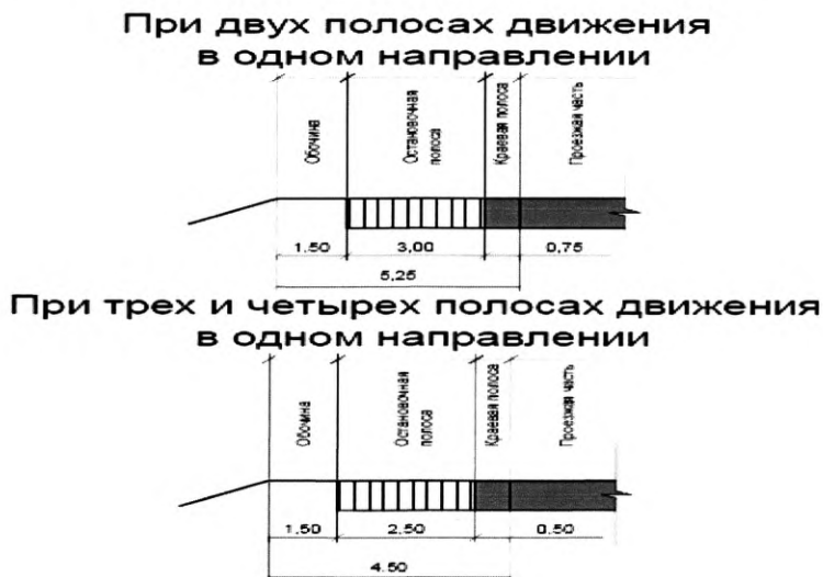
Рис. 17 Ширина обочин для многополосных дорог
