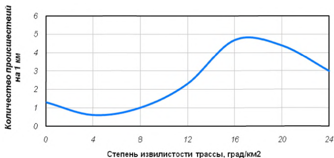
Рис. 15 Зависимость аварийности от степени извилистости трассы
