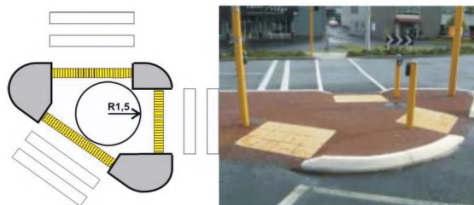
Рисунок 36– Пример обеспечения доступности островка безопасности для людей в кресле-коляске и других маломобильных групп населения
