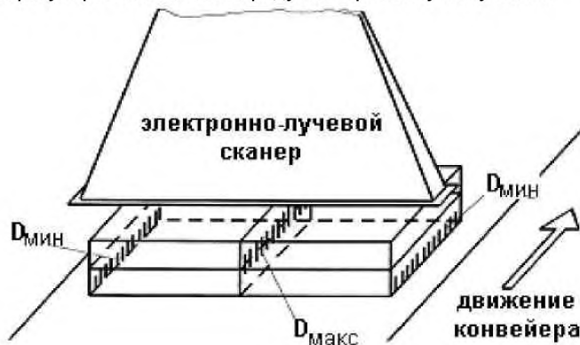
Рисунок 4 – Области D_{\max} и D_{\min} (показанные штриховкой) для случая прямоугольной технологической загрузки при одностороннем облучении электронным пучком
