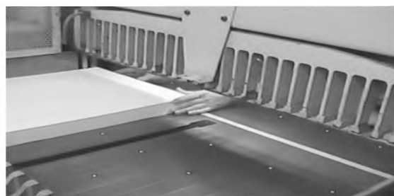
Рисунок А.5 — Руки рабочего под ножом
