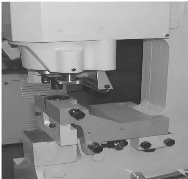
Рисунок А.1 — Опасная зона дыропробивного пресса (без каких-либо защитных мер)
