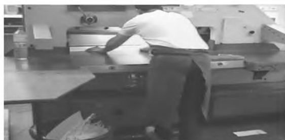
Рисунок А.4 — Позиционирование стопы бумаги
