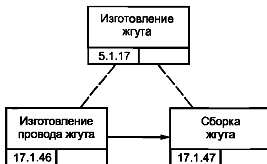
Рисунок В.4 — Процесс изготовления жгута изделия GT-350 [4]
