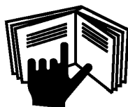
Рисунок 2 — Образец графического знака, указывающего на то, что часть информации для потребителя находится в прилагаемом ярлыке, открытке, листе-вкладыше
