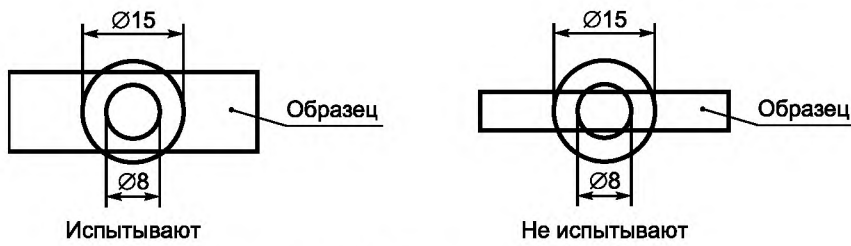
Рисунок 26 — Схема испытания по 24.1.1
