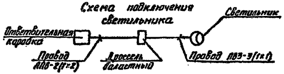
Установка светильника ПВЛМ-2х40 на крайнейте на стене
