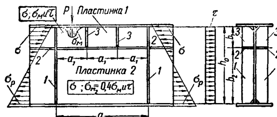
Рис. 15. Схема балки, укрепленной основными 1 и дополнительными 3 поперечными и продольным 2 ребрами жесткости
