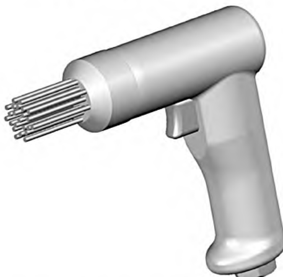
Рисунок 4 — Пучковый зачистной молоток с пистолетной рукояткой
