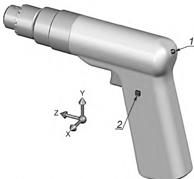
Рисунок 10 — Точки и направления измерений для сверлильной машины с рукояткой пистолетного типа
