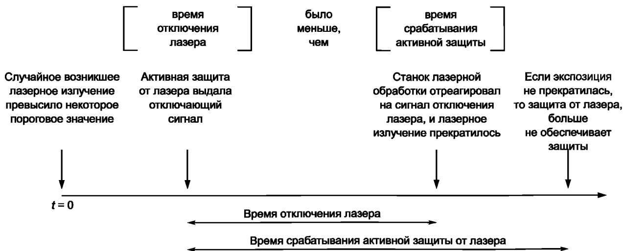
Рисунок С.2 — Пример параметров активной защиты от лазера
