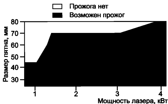
Рисунок F.14 — Стойкость к разрушению листа оцинкованной стали толщиной 1 мм от 100 с экспозиции расфокусированного пучка во время экспериментов с использованием непрерывного лазера на иттрий-алюминиевой гранате с неодимом
