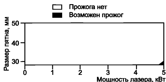
Рисунок F.3 — Стойкость к разрушению листа оцинкованной стали толщиной 2 мм от 10 с экспозиции расфокусированного пучка во время экспериментов с использованием непрерывного лазера на углекислом газе
