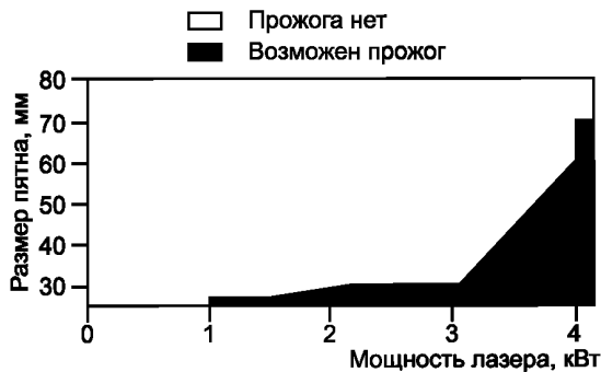
Рисунок F.13 — Стойкость к разрушению листа оцинкованной стали толщиной 1 мм от 10 с экспозиции расфокусированного пучка во время экспериментов с использованием непрерывного лазера на иттрий-алюминиевой гранате с неодимом
