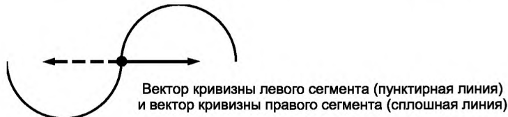
Рисунок 21 – Разрыв G2 вследствие разных направлений радиусов кривизны
