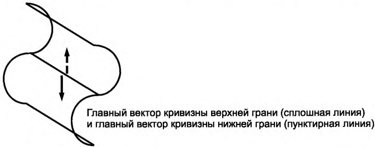
Рисунок 42 — Разрыв G2 вследствие разницы направлений вектора кривизны
