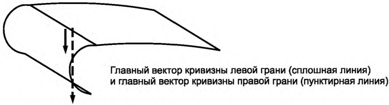
Рисунок 41 — Разрыв G2 вследствие разницы значений вектора кривизны
