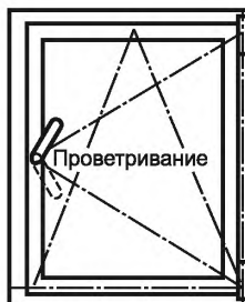
Рисунок А.4 — Поворотное (откидное, поворотно-откидное) устройство с функцией регулируемого проветривания
