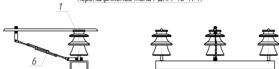
Вариант крепления устройства защиты от перенапряжений типа РДИМ-10-К-11
