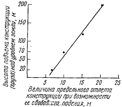
Рис. 2. Зависимость величины предельного отлета конструкции в случае ее падения при перемещении краном груза
