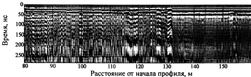
Рисунок В.3 – Пример георадиолокационного (временного) разреза
