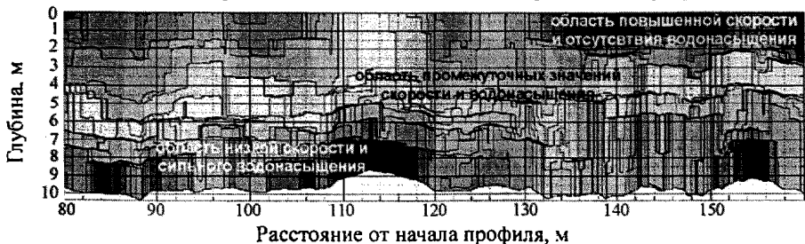
Рисунок В.4 – Пример глубинного разреза после обработки с элементами интерпретации
