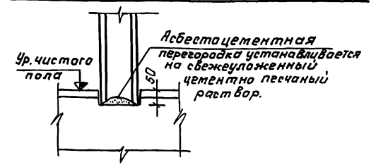
Деталь установки экструзионной перегородки
