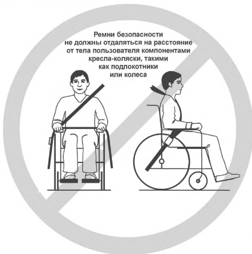
Рисунок 7 — Пример предупреждающей этикетки, иллюстрирующей неправильное положение ремней безопасности пользователя
