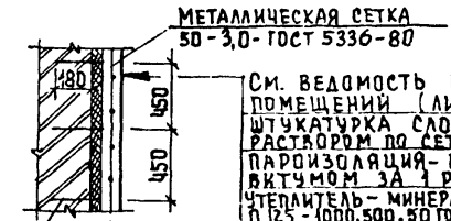
Деталь крепления утеплителя к кирпичной стене.
