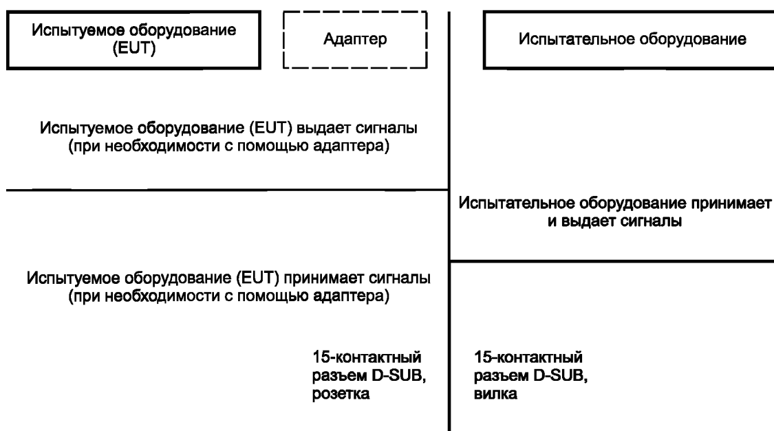
Рисунок В.1 — Схема обмена сигналами
