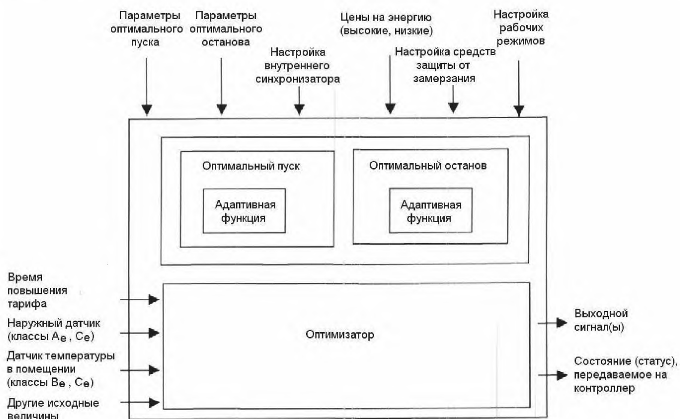
Рисунок 6 — Блок-схема оптимизатора пуска-останова
