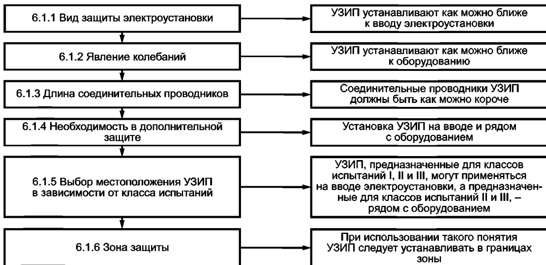
Рисунок 9 — Информационная схема применения УЗИП
